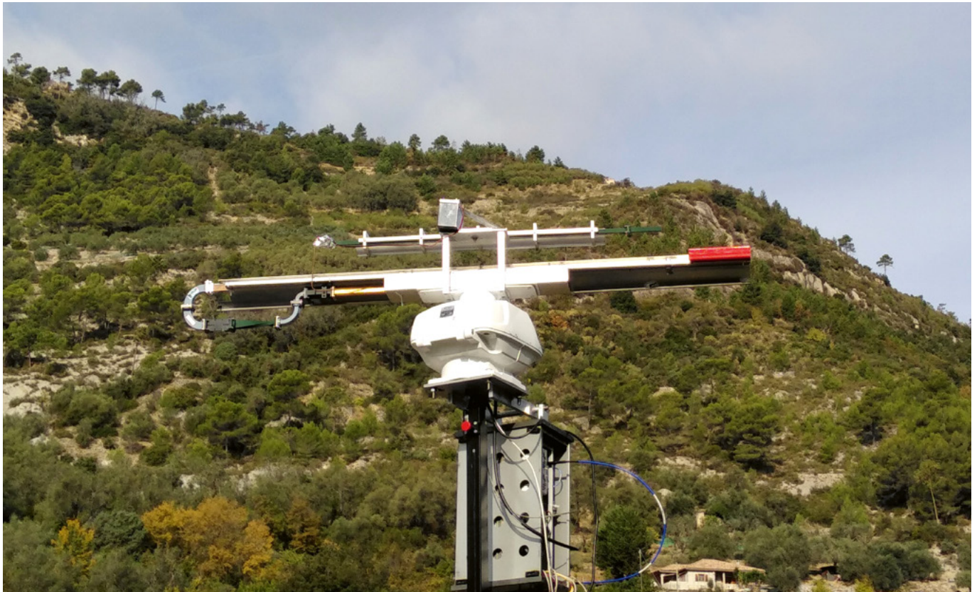
Abbildung 8: Der im Rahmen des STOPVESPA-Projekts [©LIFE STOPVESPA] entwickelte harmonische Radar.
