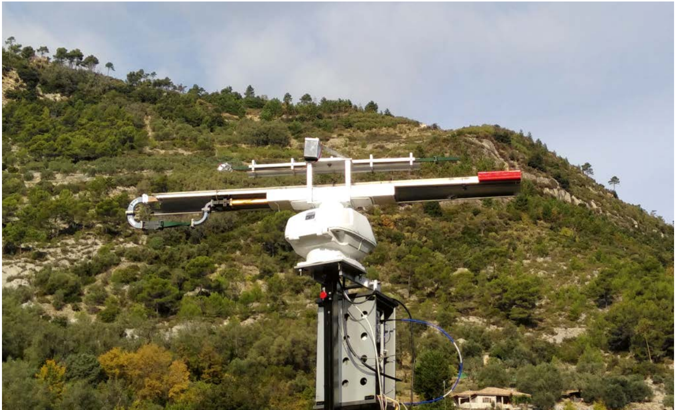
Figure 8 : Le radar harmonique développé dans le projet STOPVESPA (©LIFE STOPVESPA).
